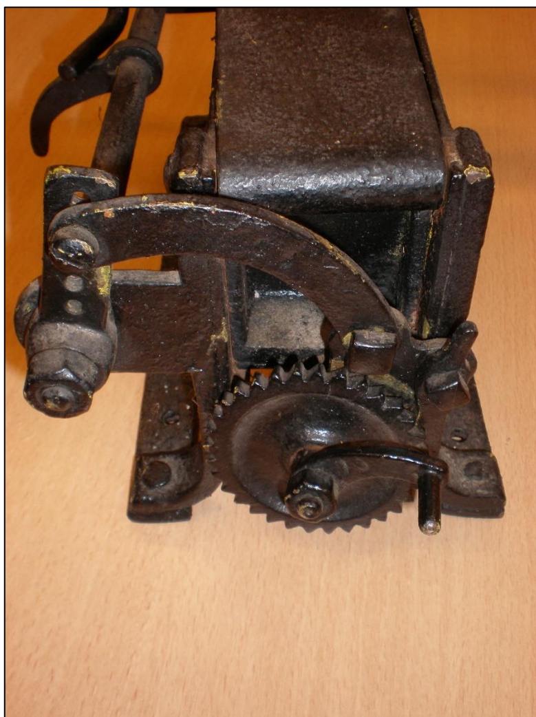
Tandwielmechanisme van de tabak snijmachine
